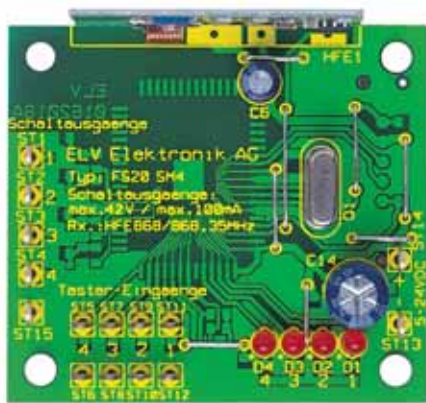
Ansicht der fertig bestückten Platine des FS20 SM4 mit zugehörigem Bestückungsplan, oben von der Bestückungsseite, unten von der Lötseite.
